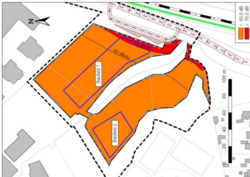
Zur Errichtung, Änderung oder Nutzungsänderung eines Gebäudes, in den nicht nur vorübergehend zum Aufenthalt von Menschen vorgesehenen Räumen, sind die Anforderungen an das resultierende Schalldämm-Maß für das jeweilige Außenbauteil (einschließlich aller Einbauten) gemäß DIN 4109 (Januar 2018) zu ermitteln.
