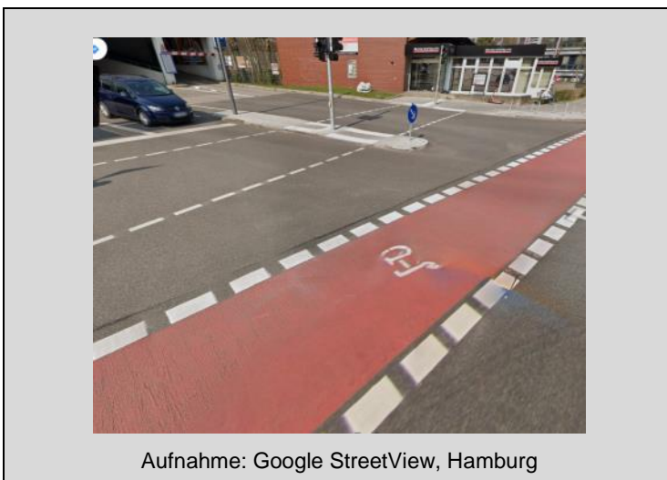
Abbildung 1-14: Radwegüberfahrt im Einmündungsbereich
