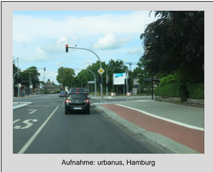
Abbildung 1-8: Benutzungspflichtiger baulicher Radweg
